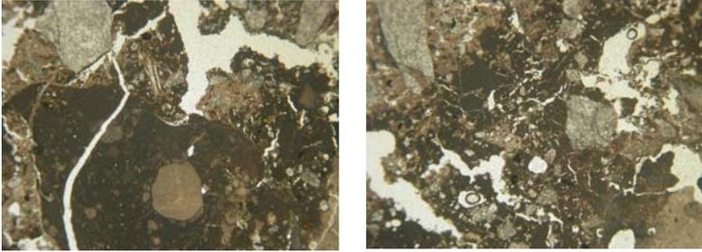
**Aspetto microscopico:** di colore marrone scuro e a struttura grumiforme. La disomogeneità della matrice micritica è dovuta ad una scarsa miscelazione della stessa, con ampie zone del tutto prive di aggregato. Da ciò deriva una elevata porosità da fessurazione con assenza di orientazione preferenziale. Fessurazione di origine primaria derivante da processi di essiccamento della calce.
