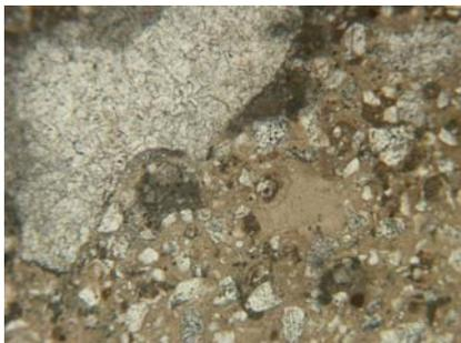
**Classazione:** (definisce l'uniformità delle dimensioni dei clasti) nel complesso i clasti sono moderatamente classati. E' possibile che l'aggregato sia stato selezionato per setacciatura.
