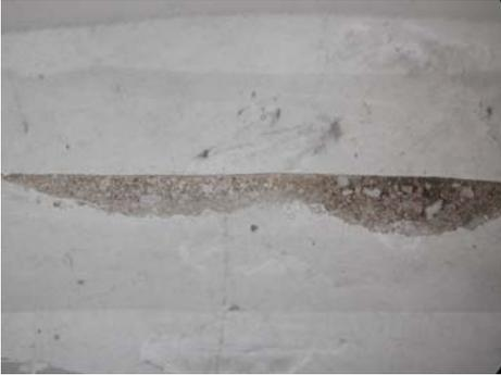
Intonaco fine di aspetto siltoso-arenaceo con buona classazione dell'aggregato. La stesura si presenta uniforme ed omogenea con colore di superficie giallo chiaro. Nell'insieme l'intonaco mostra una buona tenacità.
