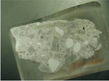
Malta di aspetto arenaceo-microconglomeratico e di colore grigio chiaro con sottile strato di pittura di colore rosso. Non si riscontrano fessurazioni macroscopiche. Assai tenace alla sollecitazione manuale.
