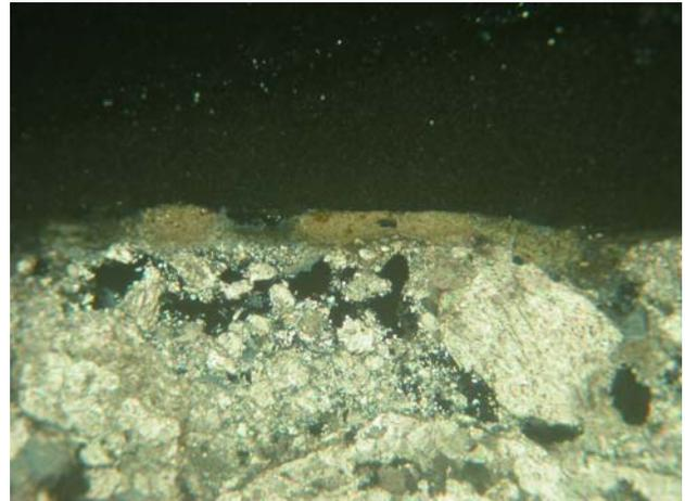
**NOTE:** In generale si nota una buona aderenza tra i granuli dell'aggregato e la matrice legante. Nella malta non si notano processi di ricristallizzazione successivi alla posa in opera. L'esame in diffrazione di raggi X del materiale (vedi allegato), ha evidenziato la presenza di magnetite ( $\text{Fe}_3\text{O}_4$ ).
