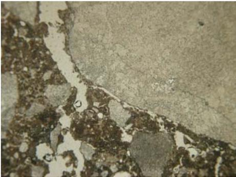
Clasti e frammenti carbonatici a struttura microcristallina.
