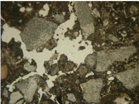
**Aspetto microscopico:** di colore marrone scuro e a struttura omogenea. La matrice micritica presenta zone ad elevata porosità da fessurazione laddove l'aggregato è più scarso. La porosità è dunque di origine primaria derivante da processi di essiccamento della calce.
