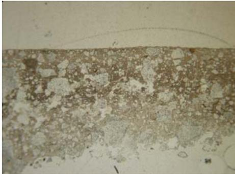
Intonaco di spessore medio di 1,25 mm su unità di stesura (substrato) di spessore non definibile.
