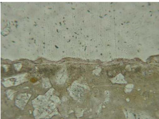
Lo strato di colore mostra una costante e regolare soluzione di continuità con l'intonaco sottostante.
