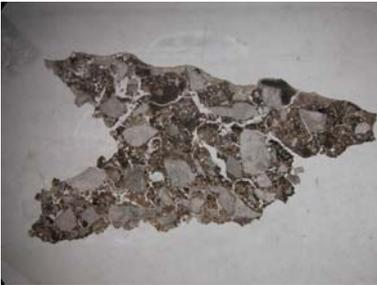
Malta grossolana costituita da clasti millimetrici in poca matrice che conferisce all'impasto una scarsa consistenza ben evidenziata dall'ampio e diffuso reticolo di fessurazione. Si riscontra una pellicola sottile di scialbatura chiara dalla quale emergono ancora i clasti del substrato.
