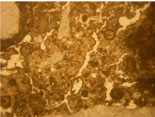
Malta grossolana costituita da clasti millimetrici e matrice in cui si evidenzia un diffuso reticolo di fessurazione.
