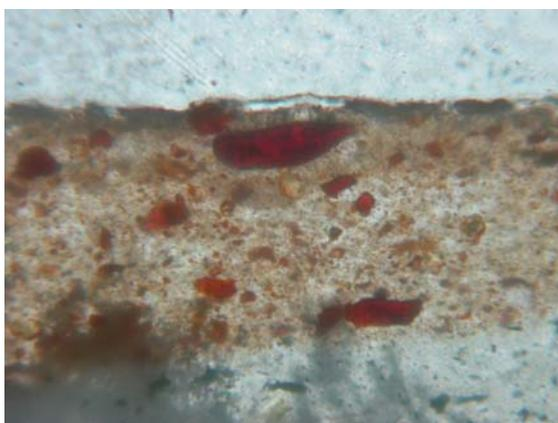
**TIPO DI MALTA:** a base di calce con aggregato calcareo.
