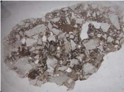
Malta grossolana costituita prevalentemente da clasti millimetrici in matrice sufficiente a conferire all'impasto una buona consistenza. La porosità è dovuta alla perdita di clasti e non si riscontrano reticoli fessurativi.
