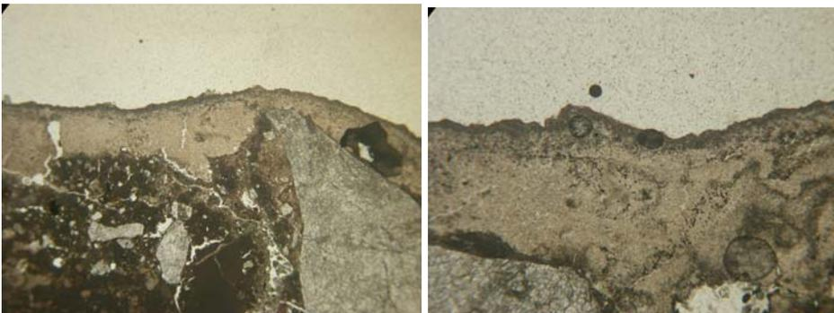
**TIPO DI MALTA:** a base di calce con aggregato calcareo.
