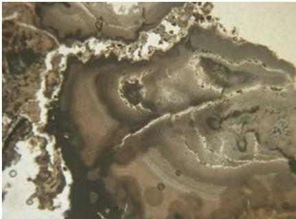
**Aspetto microscopico:** di colore marrone scuro e a struttura grumiforme. La disomogeneità della matrice micritica è dovuta ad una scarsa miscelazione della stessa, con ampie zone del tutto prive di aggregato. Da ciò ne deriva una elevata porosità da fessurazione e senza una orientazione preferenziale della stessa. La fessurazione è di origine primaria derivante da processi di essiccamento della calce.
