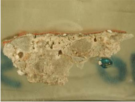
Malta di aspetto microconglomeratico e di colore grigio chiaro con clasti grossolani chiari. Sono presenti fessurazioni da ritiro, particolarmente evidenti al contatto tra clasti e matrice. Tenace alla sollecitazione manuale (si spezza ma non si sbriciola). Si rileva un sottile strato superficiale di colore rosso che attenua le irregolarità della superficie della malta.
