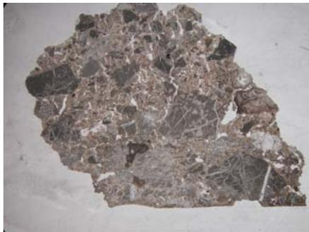
Malta grossolana costituita da clasti millimetrici e scarsa matrice in cui si evidenzia un diffuso reticolo di fessurazione.
