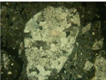
**Granulometria:** prevalentemente conglomeratica fine (8 – 4 mm) con  $\Phi$  massimo di 4 mm.
